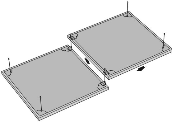
Die Panels werden durch einfaches Einrasten der Verbindungsplatten genau und fugendicht untereinander verbunden. Deren Präzision trägt zur Regelmässigkeit und Planebenheit der gestalteten Oberfläche bei, unabhängig von ihrer Grösse.
