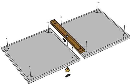
Der längliche Holzkasten aus Seekieferholz, vorgesehen für verschiedene technische Vorrichtungen, kann zwischen zwei Panels oder in eine aus Panels zusammengesetzte Fläche eingefügt werden. Je nach Bedarf kann er vor Ort oder in unserem Atelier rund oder eckig perforiert werden.
