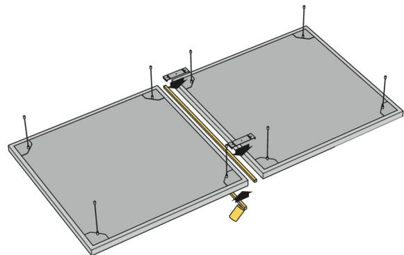
Der Verbindungssteg regelt den Abstand zwischen zwei Panels STEREO präzise und einfach und kann ohne Werkzeug fixiert werden. Er ist mittig durchbohrt, um eine Leuchtschiene anbringen zu können (bitte beachten: je nach Gewicht sind eventuell weitere Befestigungen nötig)
