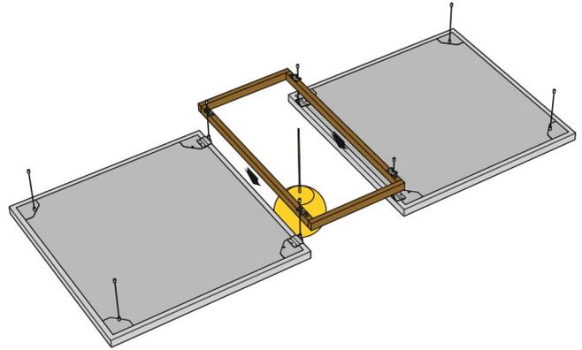
Der Hohlrahmen aus Seekieferholz wird zwischen zwei Panels bei einer Konfiguration als Deckeninsel, oder zwischen eine Reihe oder Fläche von Panels eingefügt. Der Durchlass ist gross genug für verschiedene Haustechnikelemente wie Lichtquellen, Videoprojektoren usw.
