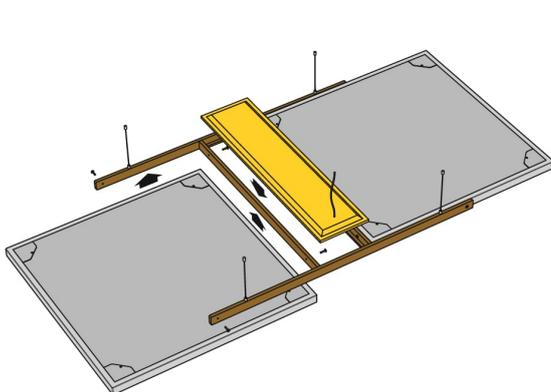
Das Akustikplateau von Texaa besteht aus zwei Akustikpanels STEREO (1200x1200mm) in einer Rahmenstruktur aus Seekieferholz mit Aussparung. Diese ist für verschiedene Lichtquellen vorgesehen, etwa eine flache, bündige Leuchte oder als Durchlass für Hängelampen. Das Plateau gehört über Besprechungs- oder Bürotische.
