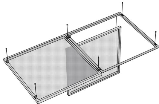
Bei Bedarf können sowohl die Akustikpanels STEREO, als auch die transparenten Panels STEREO Air als diskrete Revisionszugänge fungieren. Sie ermöglichen so einen einfachen Zugang zur Haustechnik, sind jedoch von der Gesamtdecke nicht zu unterscheiden. Ein unauffälliger Hebel erlaubt das Öffnen der Revisionsklappe.
